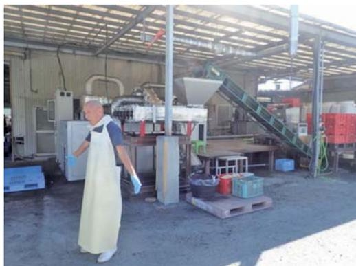
図2 低音処理炭素化装置「炭吉」(著者撮影)
